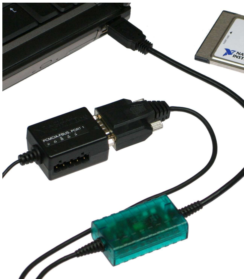
Fig. 2: DB9-konnektor er med kabel, stik og konfigureret på forhånd. Det eneste man skal gøre, er at koble instrumentet til NI-FBUS kort (ikke inkluderet), og så er man klar.
